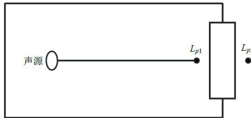
图 4-2 室内声源等效为室外声源图例
