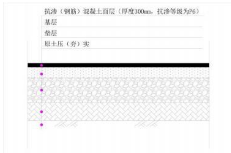
图 5-2 一般防渗区防渗结构示意图
